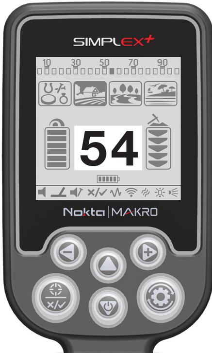
Il TARGET ID è il numero elaborato dal detector in base alla conduttività dei metalli e fornisce un'idea all'utilizzatore sull'eventuale composizione dell'oggetto individuato. Il TARGET ID è mostrato con due cifre sul display ed è compreso in una scala da 00 a 99.
