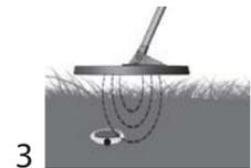
3 Pour réduire la zone de détection et mieux localiser la cible. Positionnez le disque sur le bord de la cible (mais pas au centre). Pressez  $\oplus$  pour enregistrer le seuil puis localiser la cible comme indiqué en 2
