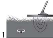
1 Positionnez votre disque à environ 2 à 5 cm du sol et à distance de la cible à détecter. Puis pressez  $\oplus$  pour calibrer le seuil.
