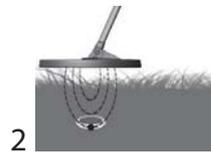
2 Allez sur la cible pour la localiser. Le signal le plus fort et le plus aigu indique la position de la cible au centre du disque.
