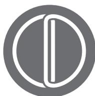
Le signal est le plus fort à l'endroit où se chevauchent la bobine de transmission et celle de réception.
