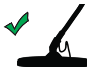
Angle du disque correct
