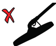
Mauvais angle du disque
