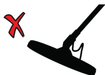
Mauvais angle du disque
