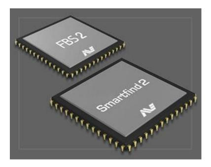
Le FBS 2 combine la transmission à ondes rectangulaires multifréquence FBS de Minelab (1,5 kHz à 100 kHz), avec des communications numériques avancées de la bobine au détecteur. Les bobines intelligentes calibrées avec précision et l'électronique du détecteur permettent une analyse de signal avancée pour une détection plus précise que jamais.
