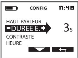
La télécommande possède une fonction de rétro éclairage. Vous pouvez définir ici la durée du rétro éclairage en secondes
