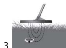
3 Pour réduire la zone de détection et mieux localiser la cible. Positionnez le disque sur le bord de la cible (mais pas au centre). Pressez  $\oplus$  pour enregistrer le seuil puis localiser la cible comme indiqué en 2
