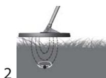
2 Allez sur la cible pour la localiser. Le signal le plus fort et le plus aigu indique la position de la cible au centre du disque.
